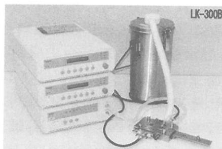
Fig. 2 温度ジャンプ型の試料温度制御装置LK-300型の外観.
