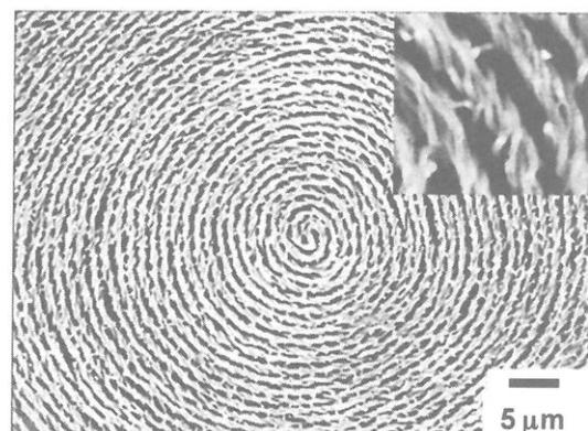
図 5 800 °C で炭素化ヘリカルポリアセチレン(H-PA)薄膜
