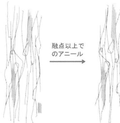
図6. nmスケールの非常に微量な大きな結晶(網掛け部分)が架橋点となり  $\mu$ mスケールの配向物を形成する模式図。融点以上のアニールにより臨界サイズ以下のnmスケールの結晶は融解し、 $\mu$ mスケールの配向物サイズが減少する。
