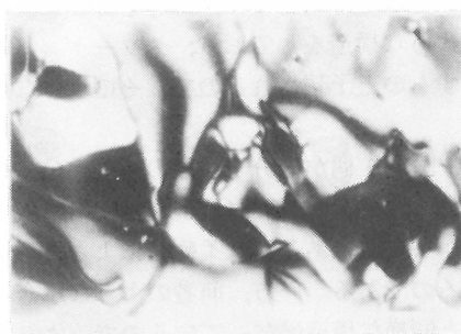
図1 高分子ネマチック液晶の糸状シュリーレン・テクスチャーの偏光顕微鏡写真。 ラセミ化PBG (分子量15万)の14% m -クレゾール溶液, 25°C
