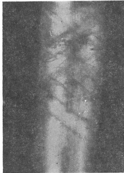
第31図 熱水中で4倍に延伸した610ナイロンフィラメントを軸方向に圧縮したものの顕微鏡写真、すべり破壊を起こしている。
