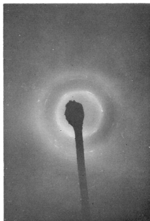
第15図 延伸 (変形) ポリエチレンエマルジョンとその電子線回折
