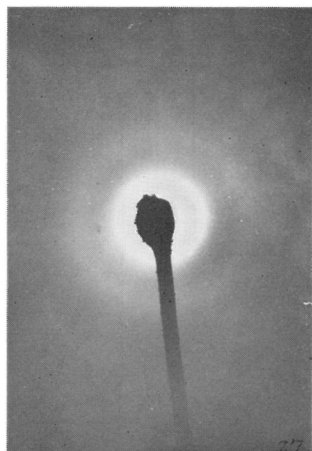
第15図 延伸 (変形) ポリエチレンエマルジョンとその電子線回折
