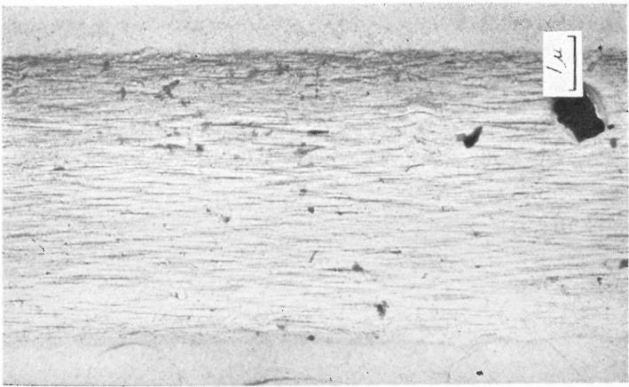
第3図 A 社製ピニロンの切断面形態 (光学顕微鏡)
