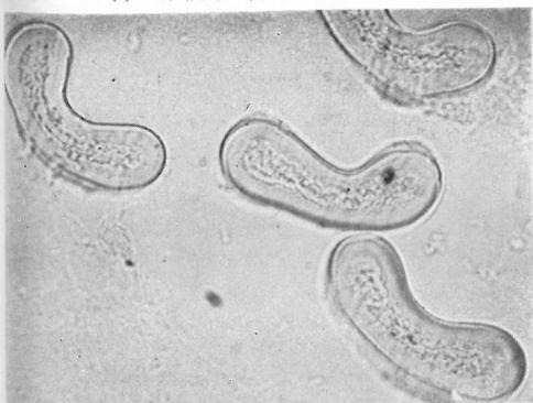
第11図 原液染ビニロンの切断面
